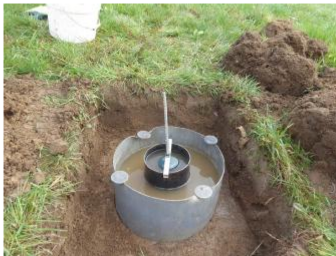
Bild 1: Auf Schicht 4 eingebautes Doppelringinfiltrometer mit Schwimmer
