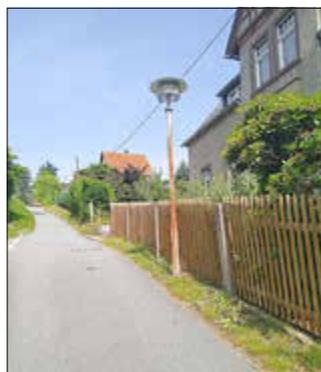
Die Straße am Knöchel ist eine Anliegerstraße, die nur im oberen Teil beleuchtet wird. Einige Bestandteile der Beleuchtungsanlagen sind verschlissen, so haben z. B. die Kabel mehrere Leiterschlüsse und Isolationschäden, mehrere Adern sind defekt. Die Leuchten sind zudem sehr stark korrodiert und teilweise nicht zugänglich. So kam es wiederholt zum Ausfall der Beleuchtung.
