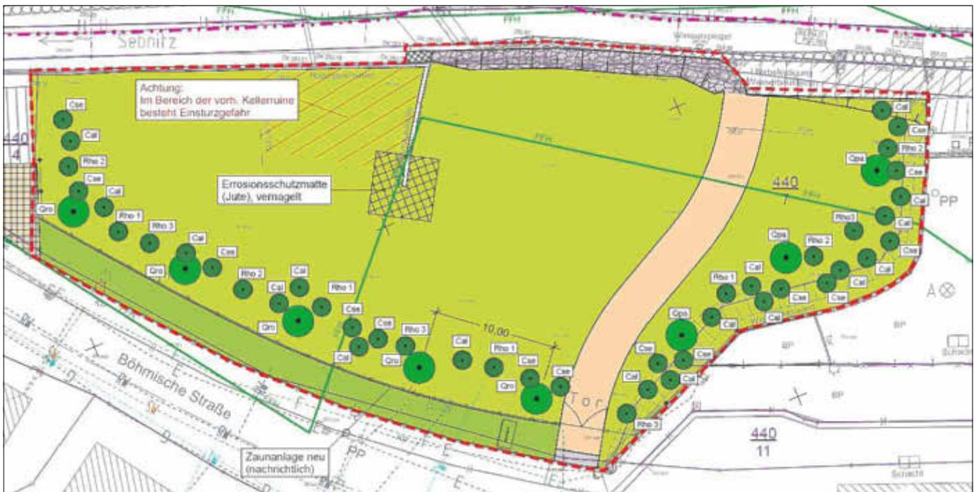
*Anpassung des Uferbereiches und der Böschung der Sebnitz – Geländemodellierung – Setzen von Granitsteinsäulen – Anbringung der Zaunfelder – Herstellung einer Zufahrt als Schotterrassen für die Landestalsperrenverwaltung – Aufbringen von Mutterboden – Ansaat mit Rasen und Wildblumenmischung*
