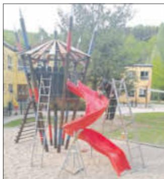
Dazu wird die Rutschenoberfläche komplett neu beschichtet. Der GFK Grundkörper wird angeschliffen, mit einer Grundierung versehen, mit signalrotem zwei Komponenten-Lack gerollt und final mit einem Klarlack überzogen.
