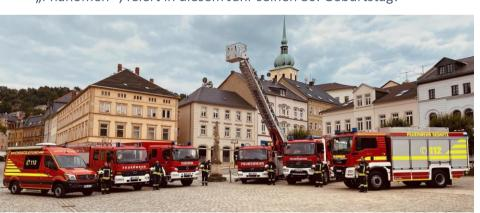
Von links: unser rollendes Kommandoquartier (ELW 1), Tanklöschfahrzeug TLF mit hydraulischem Rettungsgerät für die technische Hilfeleistung, Gerätewagen Logistik mit vielseitiger Ausstattung (GWL 2), Drehleiter (DLK 23/12) Löschgruppenfahrzeug (LF20) und unser Neuzugang Tanklöschfahrzeug (TLF 4000), nicht im Bild unser Mannschaftstransportwagen
