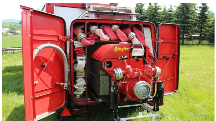
Tragkraftspritzenanhänger (TSA) mit TS8/8 Ultra Leicht & 600m Schlauch
